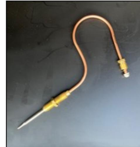
Wurde nach Überprüfung der Kontaktierung des Thermoelements mit dem jeweiligen Gashahn und Überprüfung der sauberen Verlegung der kupferfarbenen Leitungen keine Verbesserung erzielt, ist **das Thermoelement möglicherweise defekt**.
