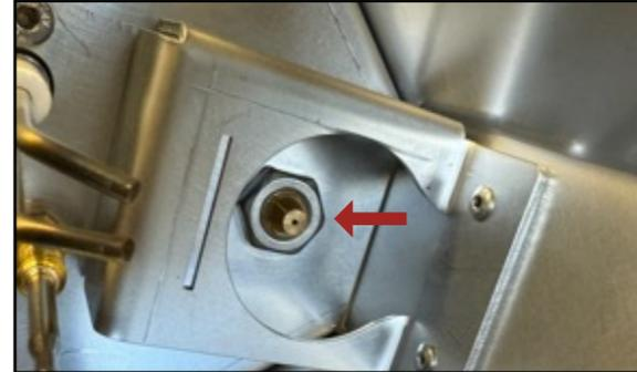
8 & 9. Die Düse des Röstbrenners aus der Halterung lösen, hierfür Edelstahlmutter abschrauben (17er Nuss oder Schlüssel), auf der Rückseite kontern (14er Gabelschlüssel)- Anschließend die Düse aus der Halterung ziehen
